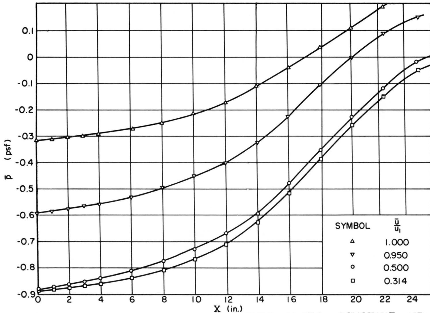
FIG. 18 VARIATION OF STATIC PRESSURE ALONG CONSTANT VELOCITY RATIO LINE FOR  $U_{\infty} = 45$  fps
