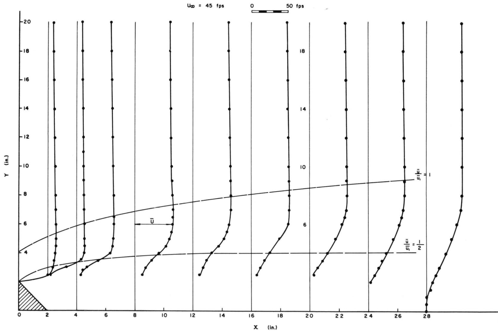
FIG. 12 MEAN VELOCITY DISTRIBUTION BEHIND THE 2" x 2" WEDGE HILL
